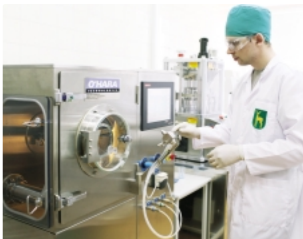
Инженер Центральной заводской лаборатории Андрей Димаков осуществляет работу по нанесению покрытия на опытные серии твердых лекарственных форм
